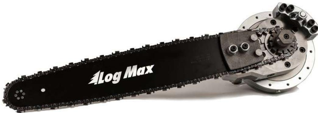
El componente clave del sistema True-cut es un motor de sierra inteligente, con válvulas integradas para control de velocidad de motor de sierra y control de espadín. El sistema True Cut mantiene una velocidad de desplazamiento de cadena de corte de 40 m/s casi constante.
